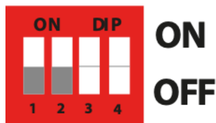
Abbildung: DIP-Schalter für die Adressierung
