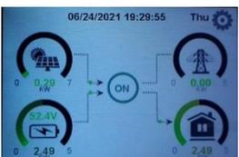
Sollte mehr Strom verbraucht werden als die Solarmodule erzeugen, regelt der Bosswerk Hybrid Wechselrichter die Entnahme aus dem Haus-speichersystem oder dem öffentlichen Netz.
